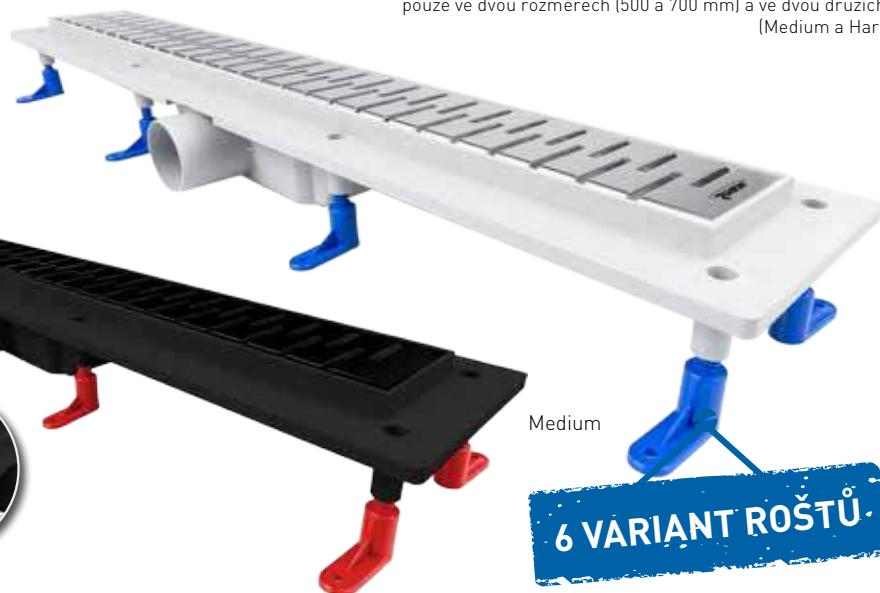
Tělo žlabu je vyrobeno z pevného a odolného plastu a rošt z velmi kvalitní nerez. Dvojitá pachová uzávěra minimalizuje pravděpodobnost pronikání pachů z odpadu do interiéru i v případě delšího nepoužití a vyschnutí sifonu. Kvalitní sifon navíc zaručuje dobrý odtok vody s kapacitou až 60 l/min.
